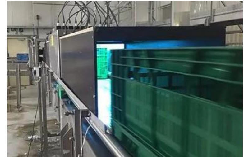
Знезаражуюча УФ система ПРОМІНЬ-Т ( https://www.waterlight.pro/holodne-znezarazhennya/dezinfekciya-zvorotnoyi-tary/ ).
